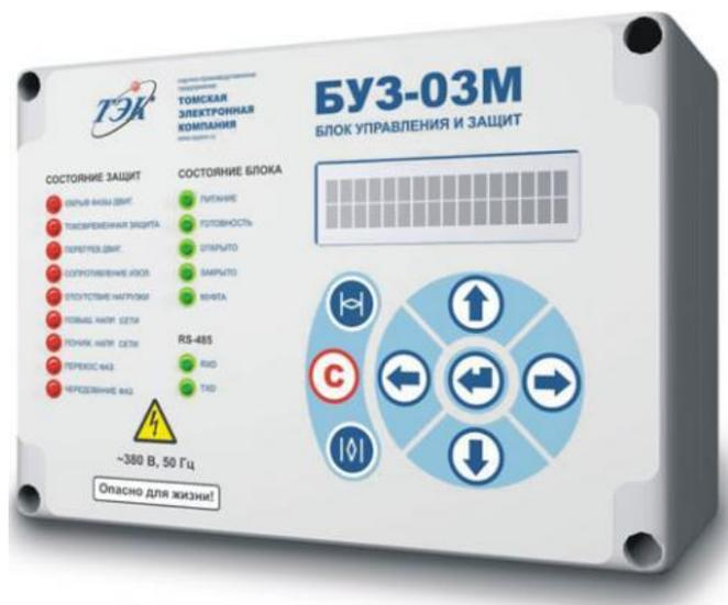
Рисунок 4.18 – Электронный блок управления БУЗ-03М
