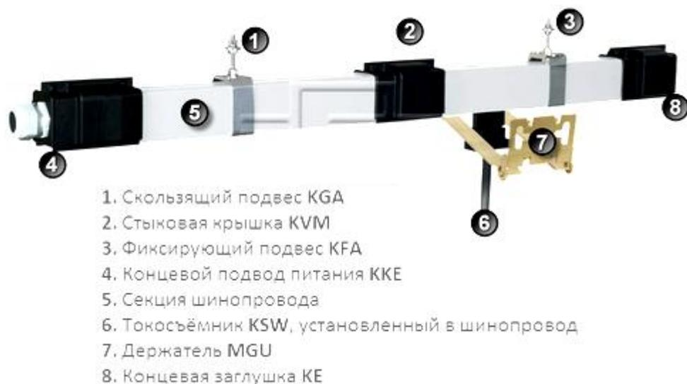
Рисунок 4.7 – Троллейный шинопровод КВН
